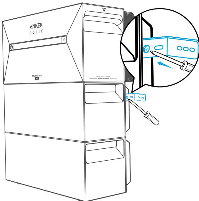
5. Markieren Sie die Position der Bohrlöcher auf beiden Seiten und verwenden Sie eine Bohrmaschine mit einem  $\phi 8$ -Bohrer und einer Tiefe von 60 mm.
