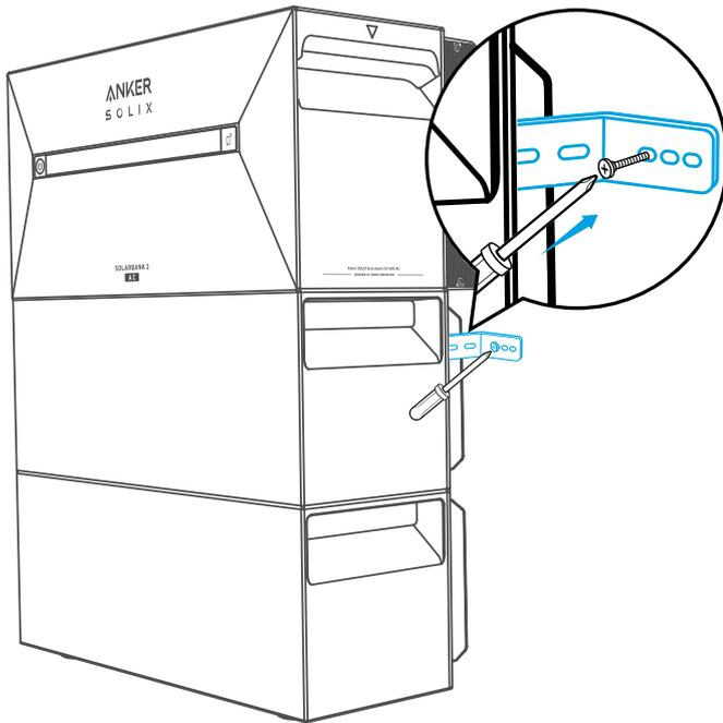
7. Verwenden Sie einen Kreuzschlitzschraubendreher, um die Kombi-Kreuzschlitzschrauben M5×10 an der L-förmigen Wandhalterung zu befestigen. Befestigen Sie dann die Verriegelungshalterung mit den Kombi-Kreuzschlitzschrauben M5×10 am Erweiterungsakku, um die Installation abzuschließen.
