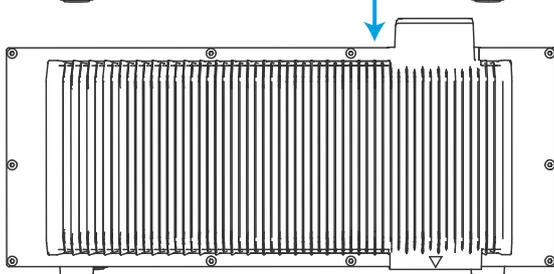
4. Befestigen Sie die L-förmige Wandhalterung an beiden Seiten des ersten Erweiterungsakkus unter der Solarbank mit Kombi-Kreuzschlitzschrauben M5×10.
