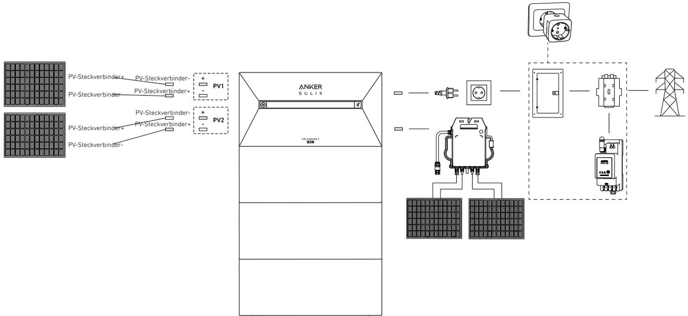
1. Schließen Sie die Solarbank mit dem mitgelieferten AC-Kabel mit Schukostecker (5 m) an den Mikrowechselrichter oder an eine Steckdose an.
