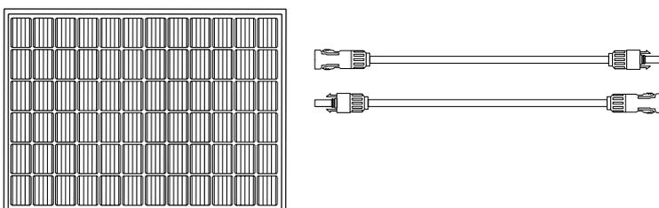
3. Verbinden Sie jeden Satz PV-Module mit jedem Satz PV-Eingangsanschlüsse in der Solarbank mit dem mitgelieferten Anker SOLIX Solarpanel-Verlängerungskabel (3m).
